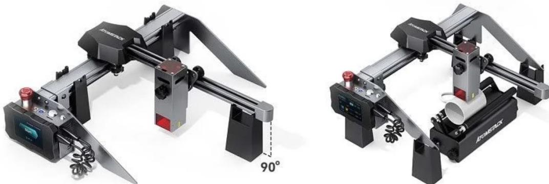
**Le kit de gravure comprend 4 supports stabilisants** – pour un alignement parfait de la machine par rapport au matériau. Ils sont également utiles pour graver en utilisant un accessoire rotatif, ce qui augmente la hauteur.
