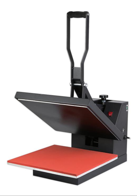
Pour éviter que les objets ne collent à la plaque de chauffage, un tapis en téflon est utilisé. De plus, dans la partie inférieure, un tapis en silicone haute température amovible est installé, contrairement aux tapis collés des autres appareils de ce type. Si le tapis est endommagé, il suffit de le retourner et d'utiliser l'autre côté.
