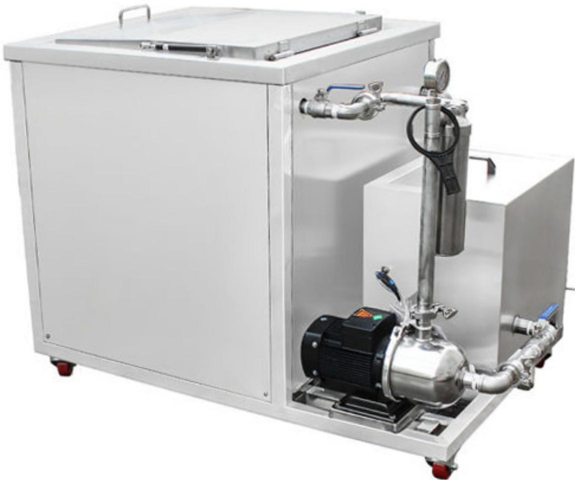
**Il est fabriqué en acier inoxydable et soudé à la main avec de l'argon, garantissant une durabilité incroyable pendant l'utilisation.**
