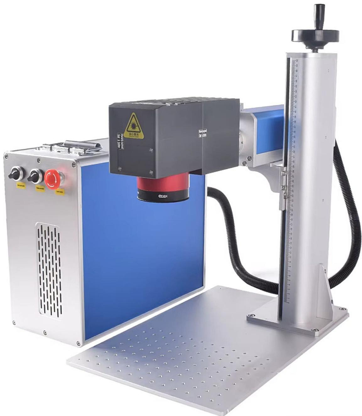
Grâce à la **tête de technologie 3D**, vous pouvez graver profondément sur des objets de forme irrégulière, comme des sphères, des surfaces courbes, des anneaux, des objets cylindriques et bien d'autres formes irrégulières que les graveurs laser FIBER 2D classiques ne peuvent pas traiter.
