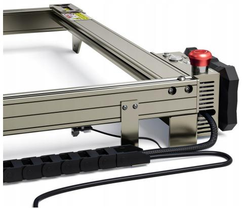
• Construction ultra légère et durable - la machine à graver ne pèse que 5,5 kg, son cadre est entièrement constitué de profilés en aluminium durables. L'assemblage de tous les éléments de la machine ne prend pas plus de 15 minutes. Il peut être déplacé librement d'un endroit à l'autre, et la zone de travail peut atteindre 400 x 400 mm avec possibilité d'extension jusqu'à 950 x 400 mm. Cela offre un large éventail de possibilités en termes de réalisation de projets!
