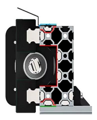
Les trous de montage dans les profilés sont étroitement espacés pour non seulement bloquer les copeaux, mais aussi renforcer les emplacements de fixation sur le rail.
